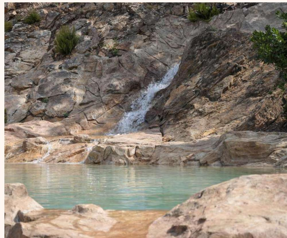
Nos cascades sont construites en béton armé et rochers reconstitués avec de nombreuses réservations pour la végétation. L'arrosage et l'éclairage sont dissimulés dans les rochers.
